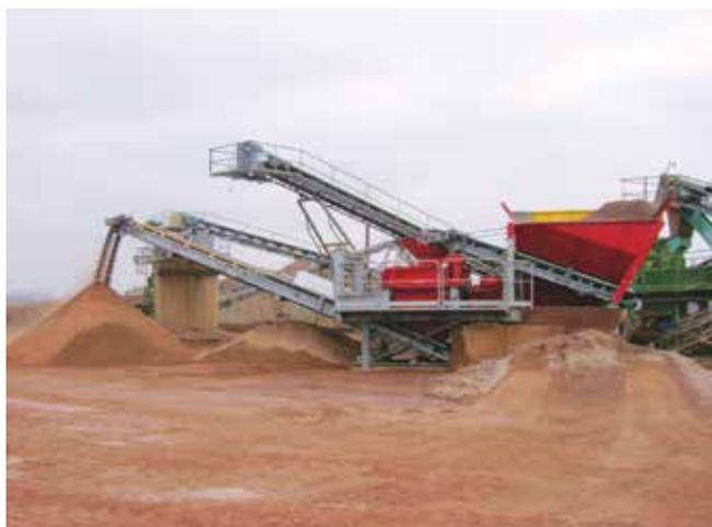
Все дробильно-сортировочное оборудование компании SBM Mineral Processing GmbH для российского рынка адаптировано под условия эксплуатации в суровых климатических условиях. А именно, используются специальные масла, смазки, фильтры, датчики, а также в процессе конструирования и производства закладывается большой запас прочности оборудования. Поставляемое оборудование работает практически на всей территории России и стран СНГ.
